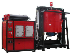
Système autonome et auto-nettoyant à racleur
